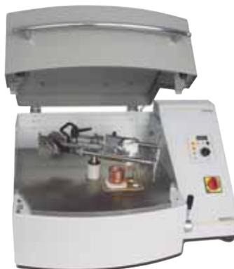
gang sowie eine neuartige Tiegelsicherung. Der Einstellmechanismus mit Zahnsegment und die neu vorgegebenen Markierungen für verschiedene Muffelgrößen am Schleuderarm ermöglichen ein noch schnelleres Arbeiten.
