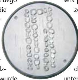
sers punktuell geschmolzen. Dabei baut sich genau die Form auf, die als Datensatz vom Labor übermittelt wurde. Erster Lizenznehmer des Bremer Dentalunternehmens ist die Eos GmbH. Sie ist das führende Unternehmen für Laser-Sinter-Verfahren, die auch das Laser-Schmelzen umfassen. Die erworbenen Lizenzen berechtigen Eos, weltweit die Bego-Patente zur direkten Herstellung von Zahnersatz mithilfe der Eos-Technologie zu nutzen.
