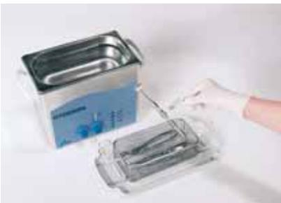
Zahnärztliche Instrumente werden meist im Tauchbad desinfiziert, jedoch muss die Reinigung konventionell in einem Zwischenschritt erfolgen. Dieser kann mit dem neuen Hochleistungs-Ultraschall-System Dürr Hygasonic entfallen: Reinigung und Desinfektion erfolgen in einem einzigen Arbeitsschritt. Je nach eingesetztem Desinfek-
