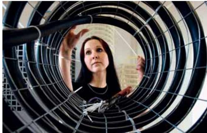
Über und unter der Erde muss die Technik stimmen. Rechts die Rohrspiralen, die etwa vier Meter tief eingegraben dem Erdreich Wärme entziehen und über ein Rohrsystem (links) in die gute Stube bringen.
