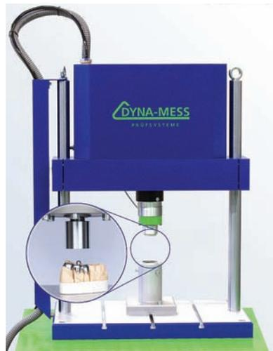
Die Prüfung von Zahnimplantaten, Brücken und Prothesen sowie von Zahnersatzwerkstoffen hat Dyna-Mess noch einfacher gestaltet. Das Unternehmen hat seine Software um ein weiteres Element ergänzt: Der neue Automatik-Regler Dyna-AC macht die
