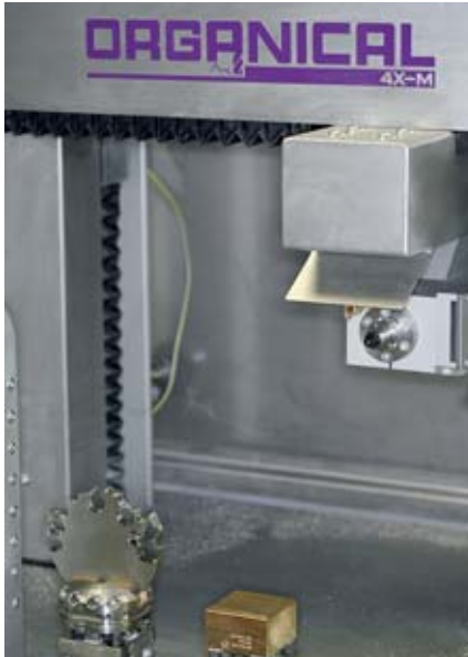
Abbildung 8: a) Fräsmaschine mit bearbeitetem Rohling (CoCrMo) (Dental-Labor Rübeling&Klar, Berlin)
