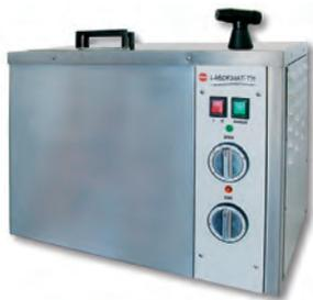
Mit der neuen Höchstleistungs-Pumpe für den Labormat TH stellt die Dreve Dentamid GmbH eine konsequente Produktverbesserung vor. Vorteilhafter Nebeneffekt: Jetzt erledigt der weiterentwickelte Ausbrüh-Automat auf Wunsch sogar zwei Prozesse gleichzeitig: die Auspolymerisierung von Heißpolymerisaten und den Reinigungs- und Sprühbetrieb für verschmutzte Modelle.
