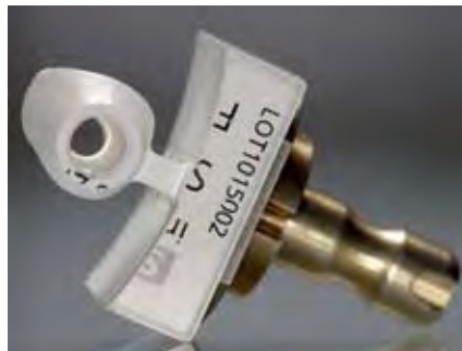
Abbildung 19: ... und nach dem Ausschleifen auf der Sirona inLab MCXL
