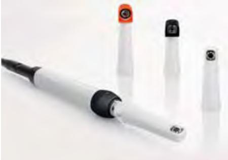
Der neueste und vierte Wechselkopf für VistaCam iX wurde speziell für die effiziente, sichere Aushärtung gängiger Dentalwerkstoffe entwickelt. Das emittierte Lichtspektrum unterstützt die Wellenlänge von 460 nm (+ 10 nm) und ist für alle Komposite und Adhäsive mit dem Photoinitiator Kampherchinon ideal geeignet. Kampherchinon wird vor-
