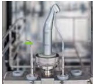
Adapter für die Scalerspitzen wurden so entwickelt, dass sowohl Innen- wie Außengewinde ideal gereinigt und gespült werden.
