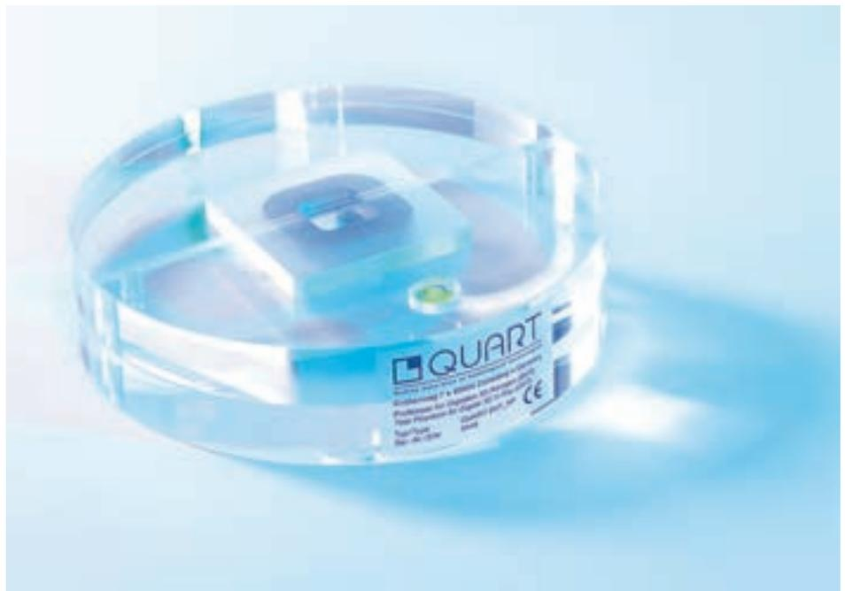
Beispiel für einen Prüfkörper zur Konstanzprüfung gemäß DIN 6868–15
