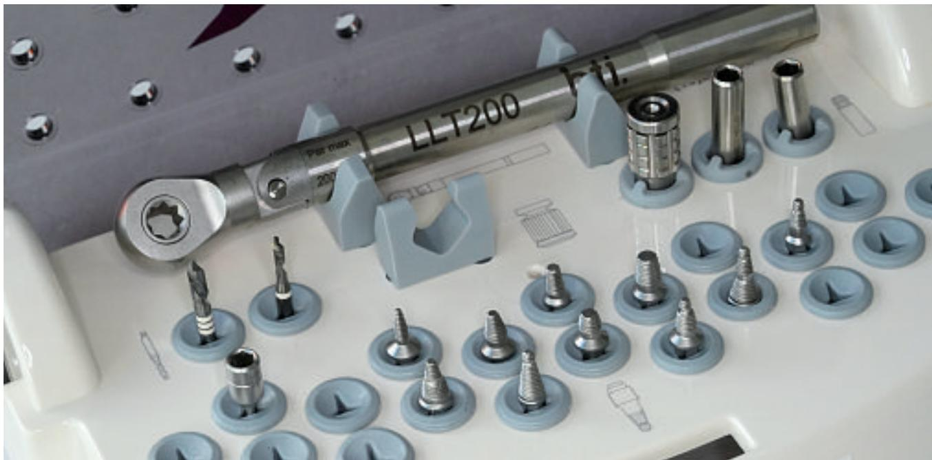
Ausdrehsatz zum Entfernen beschädigter Implantate
