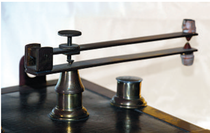
Über den Kontakt/Nicht-Kontakt der Metallspitzen wurde die Temperatur kontrolliert.
