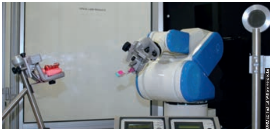
Der ORMED Putzroboter simuliert mit seinem beweglichen Arm das Zähneputzen auf einem künstlichen Teilgebiss mit simulierter Plaque.
