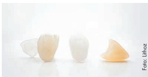
Abb. 2: Neu ist die Möglichkeit, Lithiumdisilikat zu drucken, zum Beispiel für Veneers oder eine minimal-invasive Bisshebung („Table Tops“).
