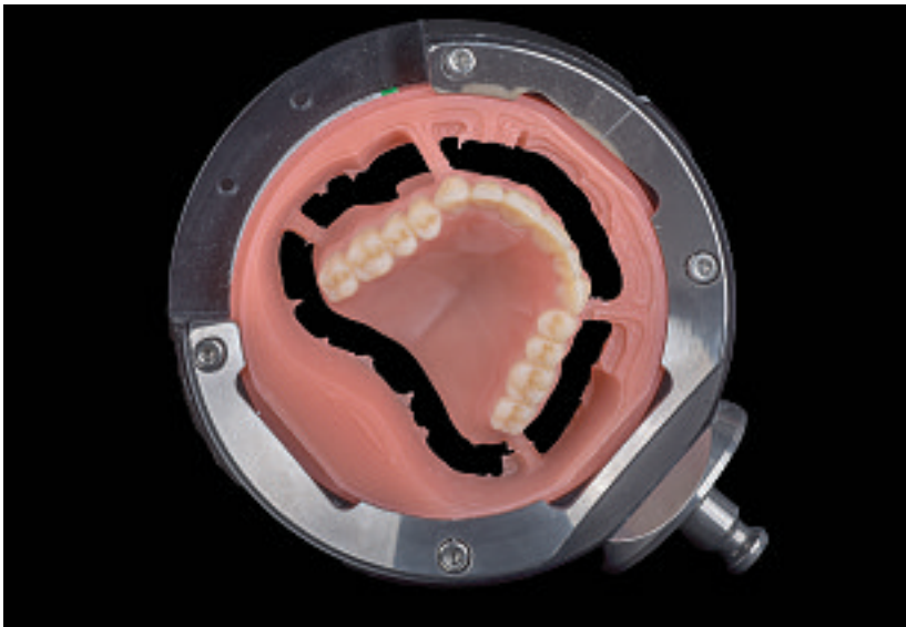
Abb. 19: Im Block gefräste Totalprothese nach Entfernung aus der Fräsmaschine (PrograMill PM7, Ivoclar Vivadent): Aufgrund der feinen Fräsung konnte unmittelbar nach Entfernung der Konnektoren die Politur an der Poliermaschine erfolgen.
