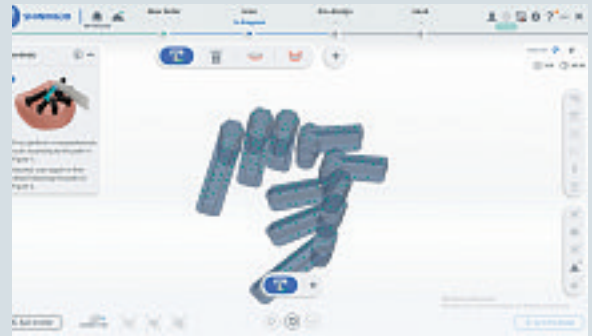
Abb. 2: Laufender Fotogrammetrie-Scan in der SHINING 3D-Software (Aoralscan Elite): Die Software erkennt automatisch die Position der Referenzmarker (Fiducial Bodies) an jedem Implantat und berechnet daraus ein präzises dreidimensionales Lagemodell aller Implantate im zahnlosen Kiefer.
